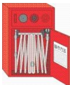
屋内消火栓設備
