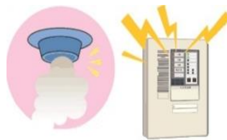
自動火災報知設備
