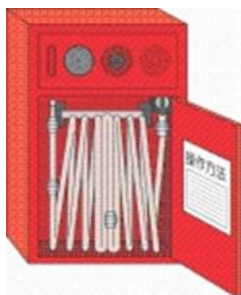
屋内消火栓設備
