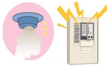
自動火災報知設備
